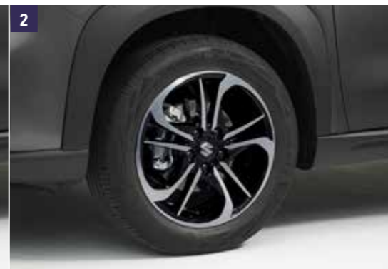
2 | Alumíniumfelni „MOJAVE” WVTA Fekete, polírozott, 6,5 J x 17”, 215/55 R17 méretű gumihoz, S-logós középkipakkal. Cikkszám: 43210-54PU1-OSP B
