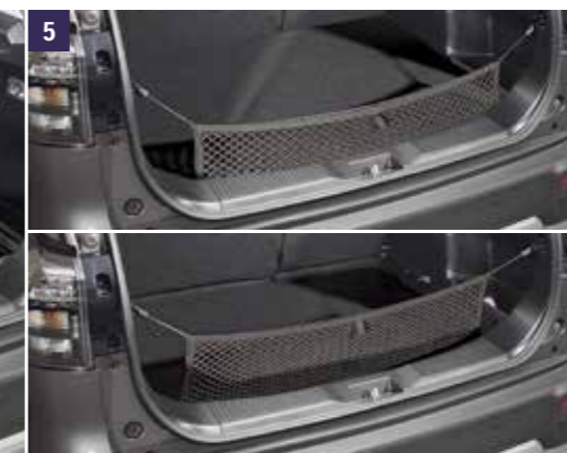
5 | Függőleges csomagtérháló Megakadályozza, hogy a csomagok kiessenek a csomagtartóból a csomagtartótető felnyitásakor. Rögzítőelemekkel együtt. Cikkszám: 990E0-59J00-004
