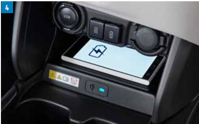
4 | Vezeték nélküli mobiltelefon-töltő 2, 3, 4 1 db, Qi töltési opcióval ellátott okostelefon töltésére alkalmas. Tökéletesen illeszkedik a középkonzolhoz. Maximális energiafogyasztás: 24 W Névleges feszültség: 12 V Üzemi hőmérséklet-tartomány: -20 °C – 40 °C Cikkszám: 39490-69T00-000
